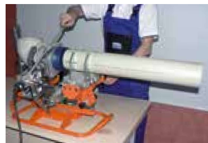
Upnutí do přípravku a vycentrování, poté nahřívání
