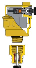
V klidové poloze je armatura uzavřena. Princip funkce spočívá ve shromažďování bublinek vzduchu, které voda obsahuje, v horní části plovákové komory. S přibývajícím objemem vzduchu dochází k poklesu hladiny provozní tekutiny v komoře ventilu. Tím klesne plovák, uvolní se ventilek a otevře odvzdušňovací cestu. Výstupní odpouštěcí hrádko je chráněno čepičkou proti prachu a nečistotám.
