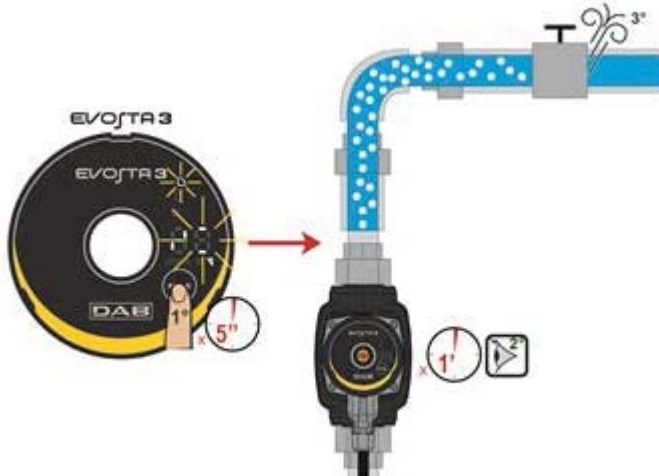
Obrázek 9: Automatické odvzdušnění čerpadla
