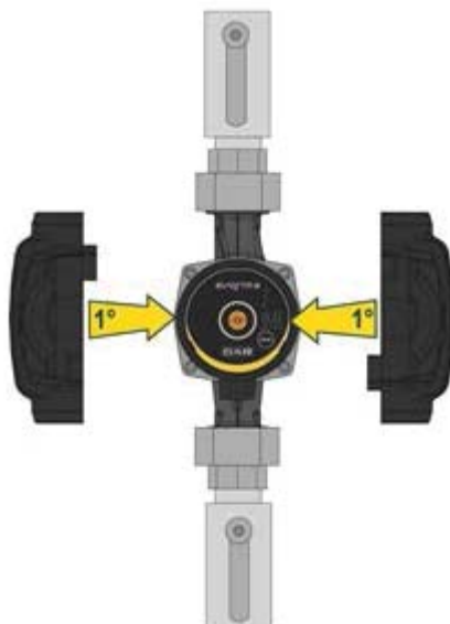
Obrázek 7: Izolace tělesa čerpadla
