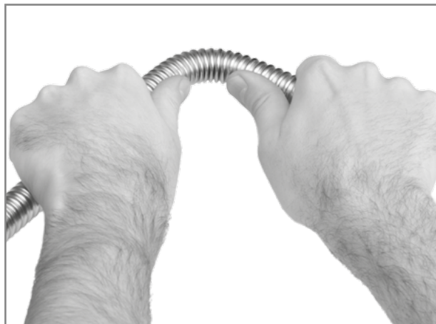
OBRÁZEK 17 – POSTUP PŘI OHÝBÁNÍ TRUBKY
